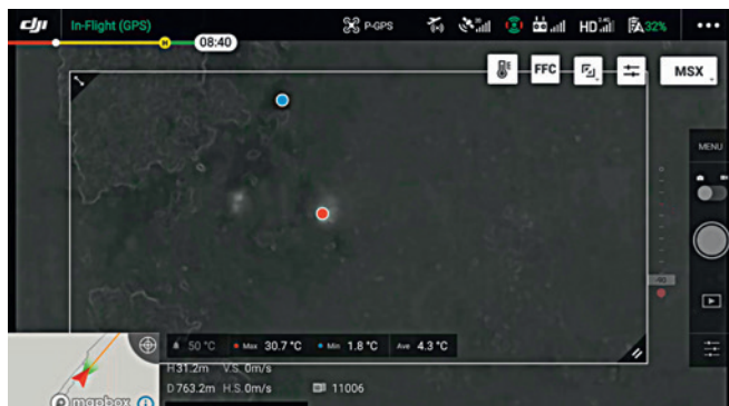
Рис. 37, 37а. Иногда очаги находятся под холодной «крышкой» из торфа и не дают высокой температуры, их можно заметить только по небольшому отличию от средней температуры земли
