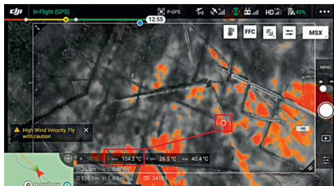
Рис. 36. Тепло-визор настроен плохо: кроме очага 104.2 °С (красная точка) видны пятна нагретой земли (большинство красных пятен)
