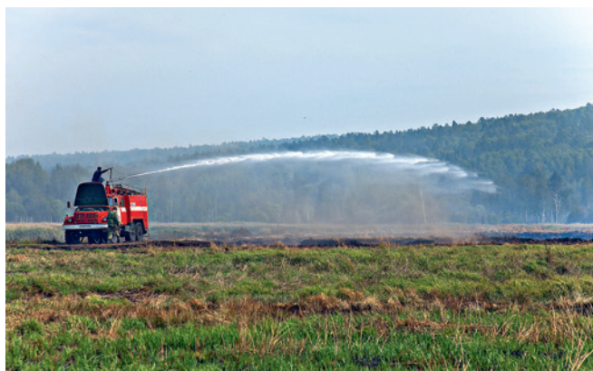
Рис. 65. Тушение от АЦ-40. Неправильно: лафетный ствол навесной струёй не обеспечивает надёжного тушения торфа. Иркутская область
