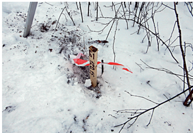
Рис. 78. Здесь репер — вбитая в землю арматура длиной 1,5 м, а деревянный кол-сторожок нужен для нанесения обозначения репера и его отметки
