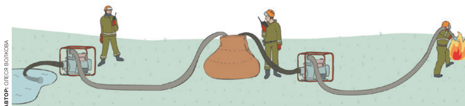
Рис. 55. Эстафетная подача воды через промежуточные ёмкости
