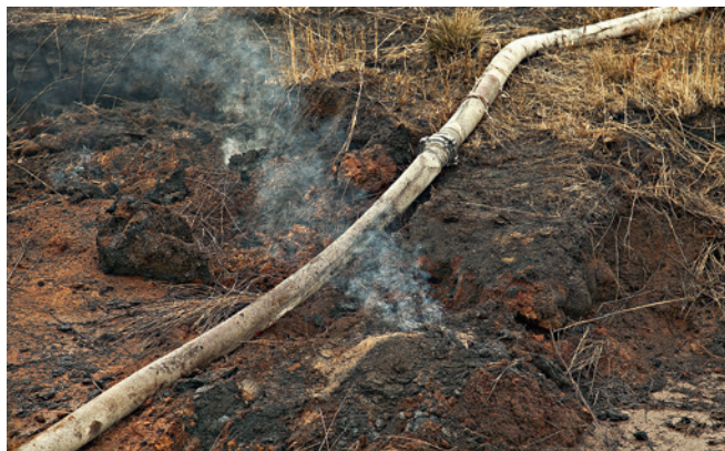
Рис. 64. Прокладка магистральной линии по горящему торфу, что неправильно: рукава сгорают. Иркутская область
