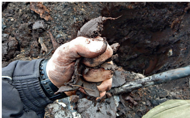
Рис. 88. Полевое определение степени разложения торфа сжиманием в кулаке
