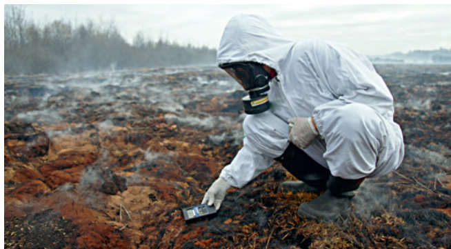
Рис. 96. Замер уровня радиации очага торфяного пожара в загрязнённой зоне. Брянская область
