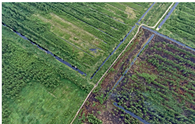
Рис. 28. Система каналов на осушенном торфянике. По отблеску и тёмному цвету видно, в каких каналах есть вода, а в каких нет
