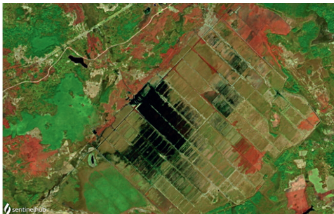
Рис. 30. На космоснимке видны гари разной давности (в режиме SWIR гари выглядят рыжими и хорошо заметны). Сначала гарь тёмная, со временем светлеет и покрывается свежей травой
