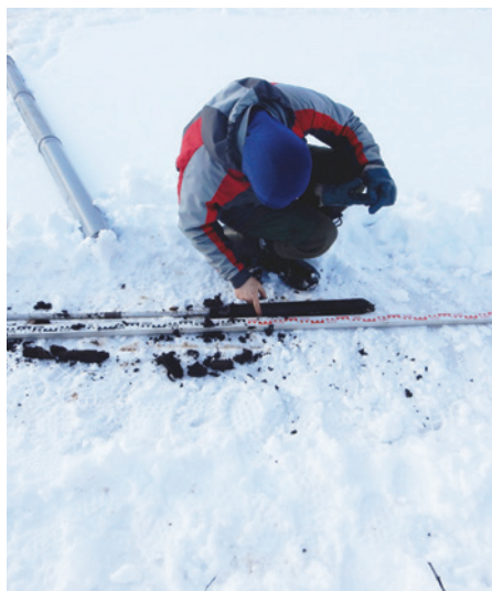
Рис. 107. Изучение керна (пробы грунта) в торфяном буре
