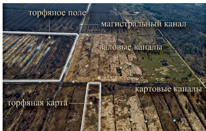
Рис. 5. Основная канальная сеть фрезерной торфодобычи и её структура (без нагорных, ловчих и других каналов)
