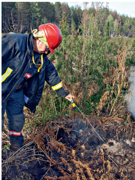
Рис. 63. Определение глубины торфяного очага щупом-термометром
