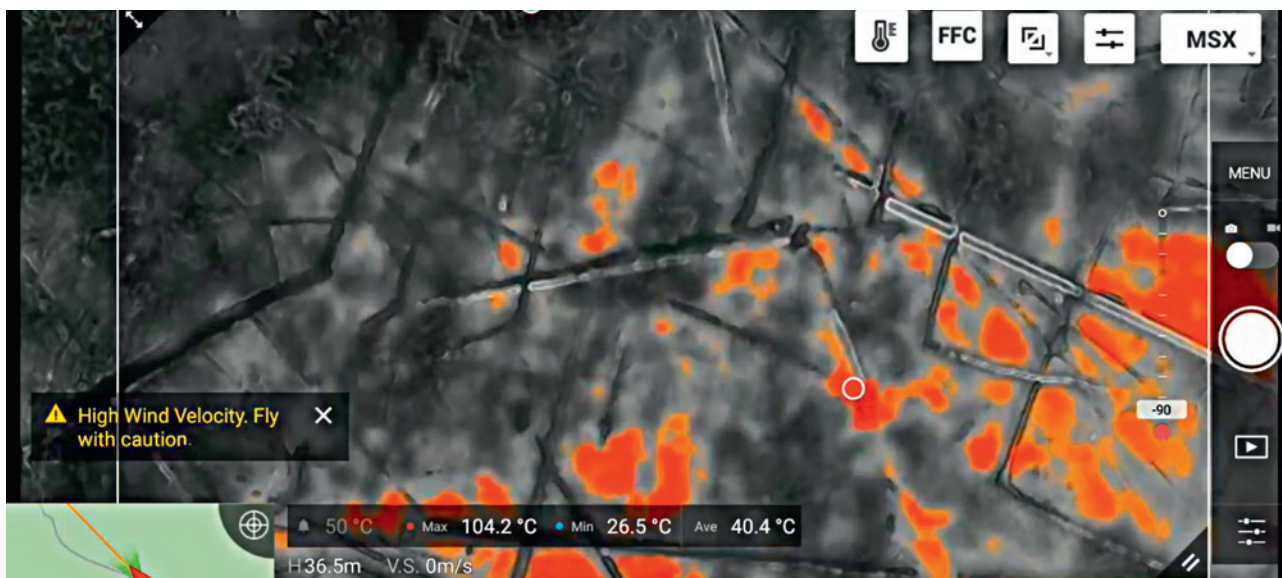
Рис. 12. Тепловизор настроен плохо: кроме очага 104.2 °С (красная точка) видны пятна нагретой земли (большинство красных пятен)
