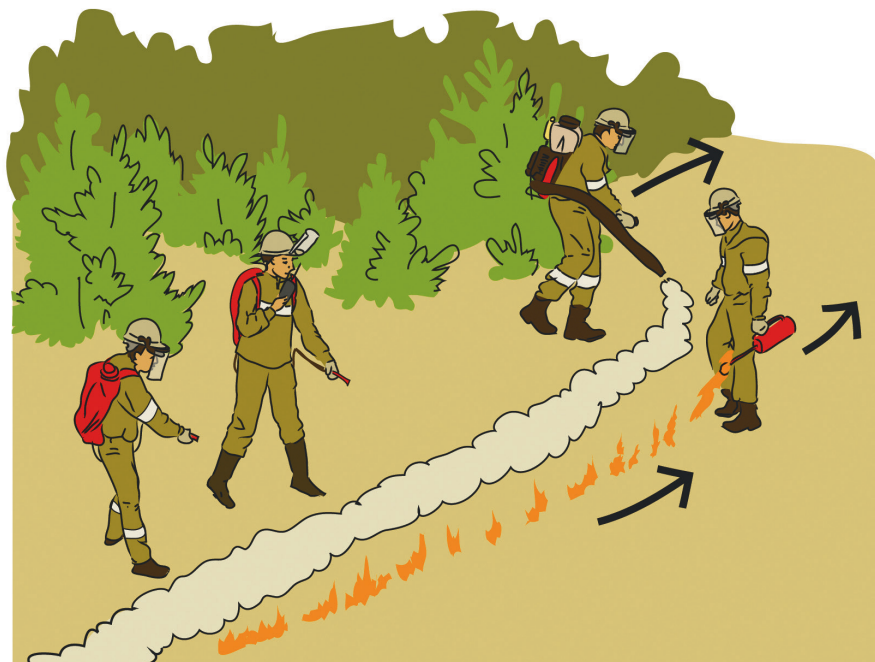
Рис. 16. Усиление опорной полосы валиком из пены с помощью РЛЮ или воздуходувки
