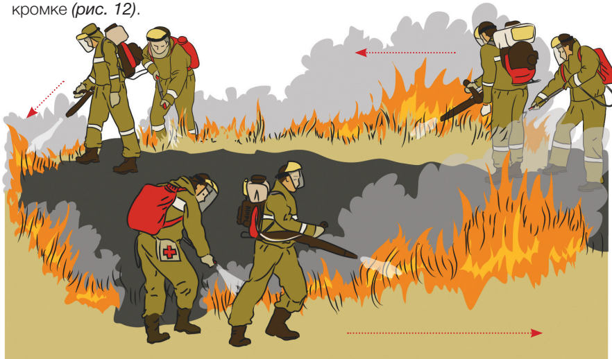
Рис. 10. Прямое тушение на горящей кромке. Тушение по всему периметру
