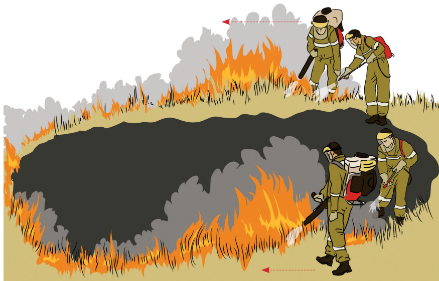
Рис. 11. Прямое тушение на горячей кромке. Тушение с фронта
