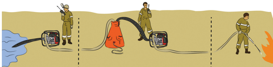
Рис. 38. Эстафетная подача воды через промежуточные ёмкости
