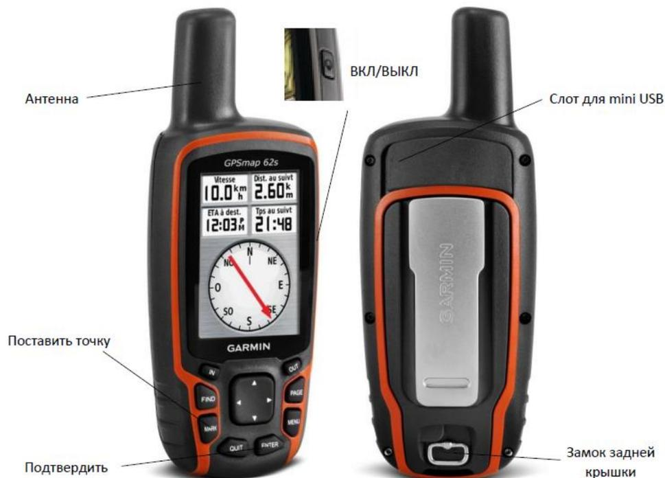
**Антенна** – необходима для приема сигналов спутника. Не снимается.
